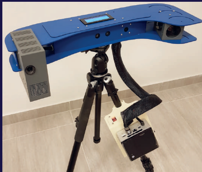
Foto: Prototyp skanera miejsca zbrodni, stworzonego przez Wydział Mechatroniki Politechniki Warszawskiej (Archiwum Robert Sitnik)
