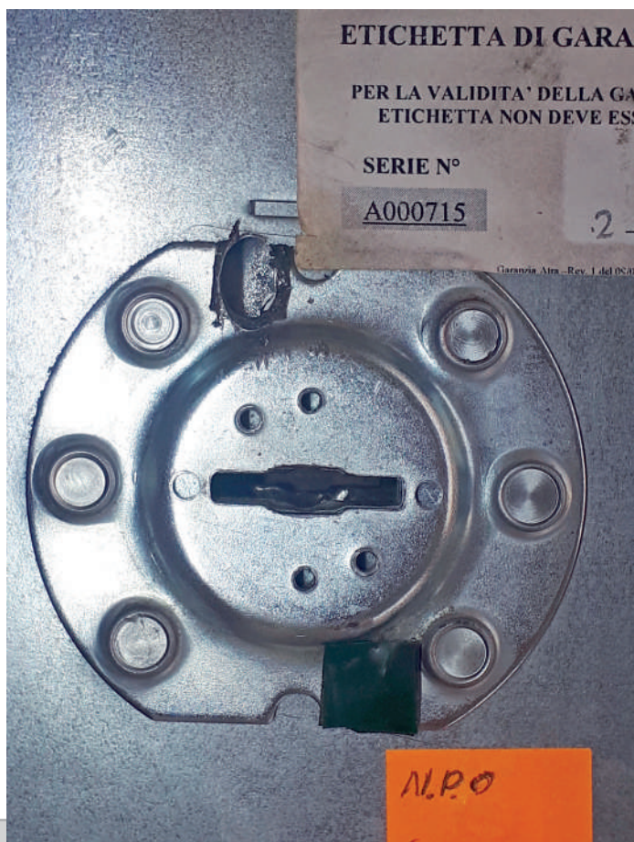
Uszkodzona obudowa zamka – ślady nawiercenia.
