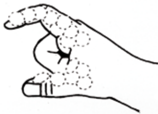
Rys. 9 Zbieranie cząstek GSR z dłoni za pomocą stolika mikroskopowego z taśmą przyklepną.
