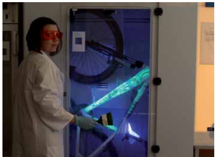
Materiał dowodowy umieszczony w komorze cyjanoakrylowej wielkogabarytowej w celu ujawnienia śladów linii papilarnych
