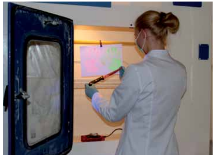
Ujawnianie śladów linii papilarnych na materiale dowodowym w komorze cyjanoakrylowej średniej wielkości
