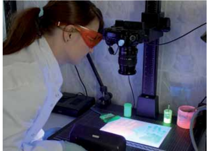
Rejestracja fotograficzna ujawnionych śladów linii papilarnych
